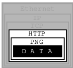
Рисунок 2. Уровни протоколов, покрываемые сокетами
